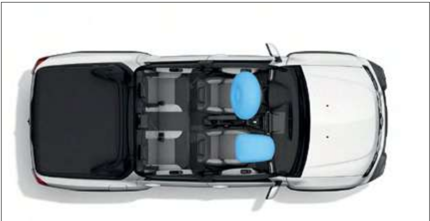
airbag Dois airbags protegem você e o seu passageiro em caso de colisão.
